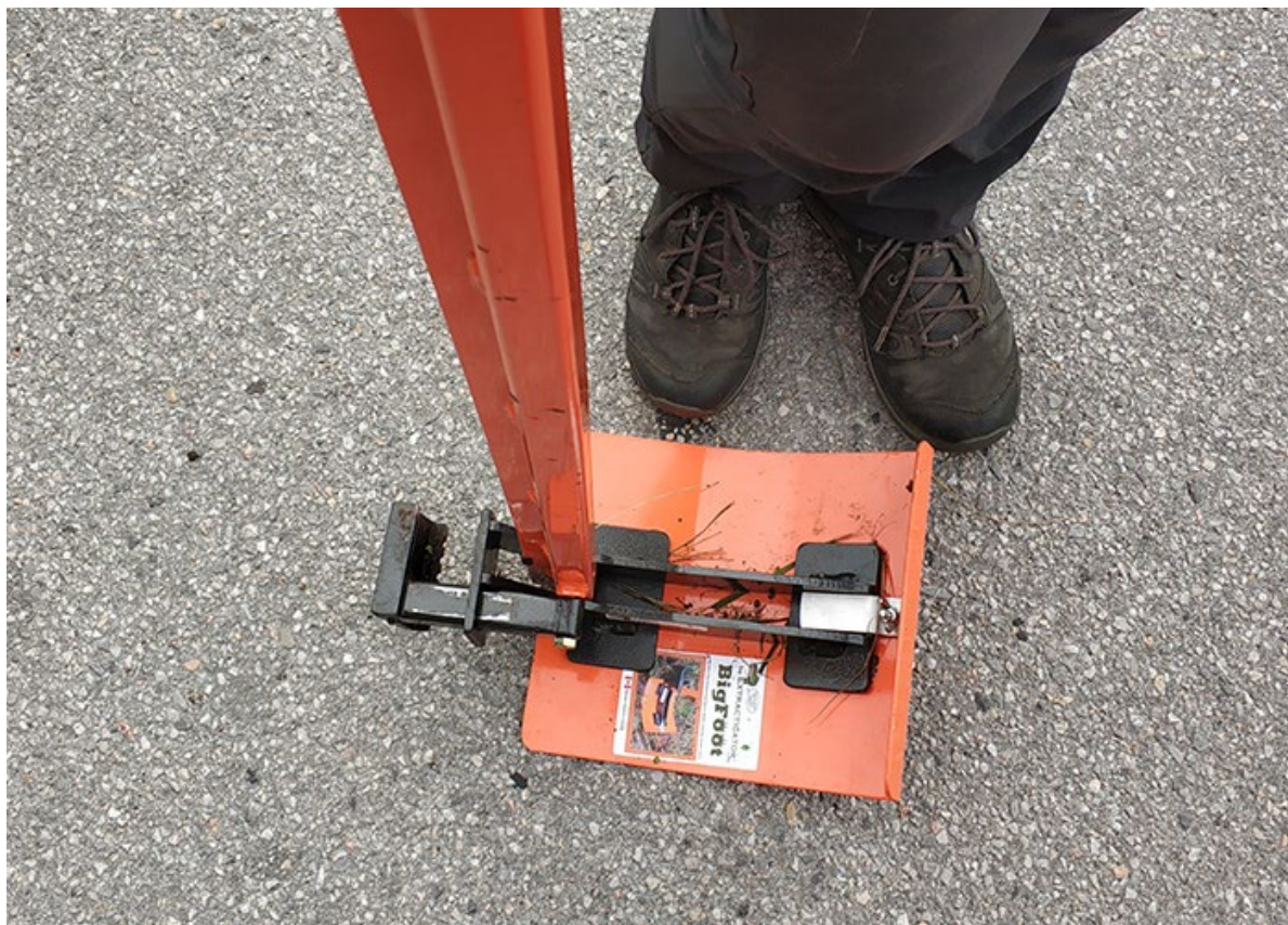
Slika 2. Orodje Extractigator z dodano ploščo Big Foot, s katerim lahko učinkovito ruvamo manjše olesenele rastline. Foto: arhiv Zavoda Symbiosis
