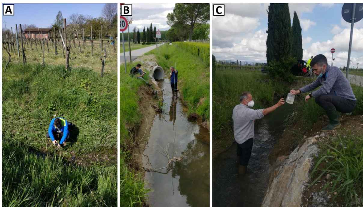
Figura 5 - A) monitoraggio dei parametri chimico fisici nel ramo principale del rio Bisinta (punto GRE_5). B) Esecuzione di misura di portata in un ramo affluente del rio Bisinta (punto GRE_3). C) Campionamento dell'acqua per la valutazione dei fitosanitari (punto GRE_3).
