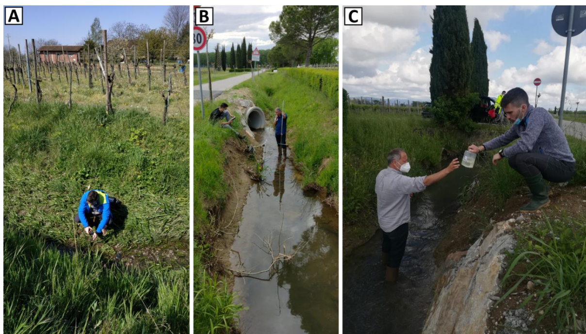
Slika 5 - A) Vzorčenje kemijsko-fizikalnih parametrov v glavni strugi Rio Bisinta (točka GRE_5). B. Izvedba meritve pretoka v strugi Rio Bisinta (točka GRE_3). C) Vzorčenje vode za vrednotenje fitofarmaceutskih sredstev (točka GRE_3).
