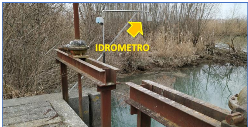
Figura 12 – Idrometro su ricettore
