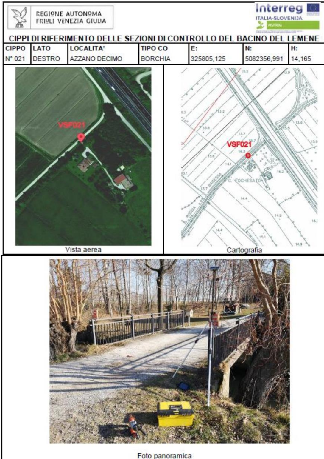
Figura 10. Esempio di monografia di testa di sezione fluviale.
