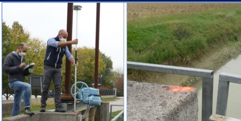
Figura 16 – Spigolo usato per confronto quote
