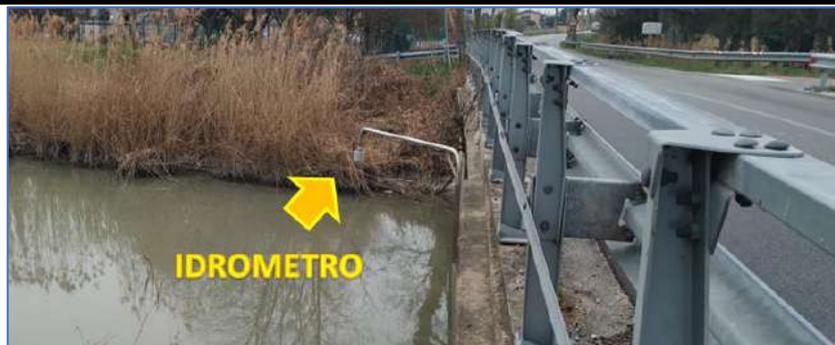
Figura 4 – Idrometro Eridania
