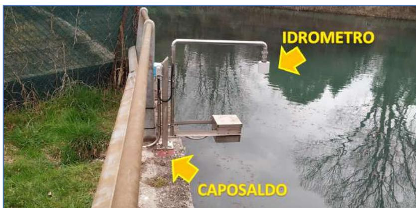
Figura 20 – Posizione idrometro e caposaldo
