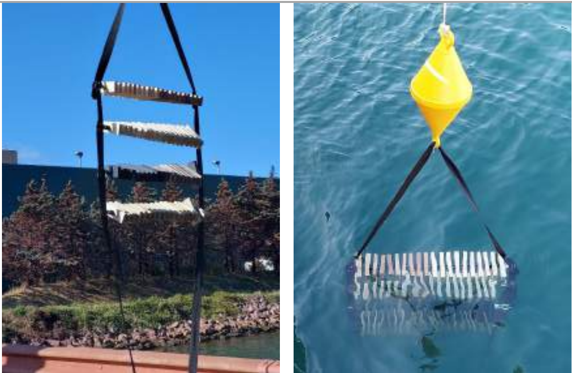
Slika 2: Izpostavitve vzorcev v morskovo vodo v Luki Koper 18.8.2021
