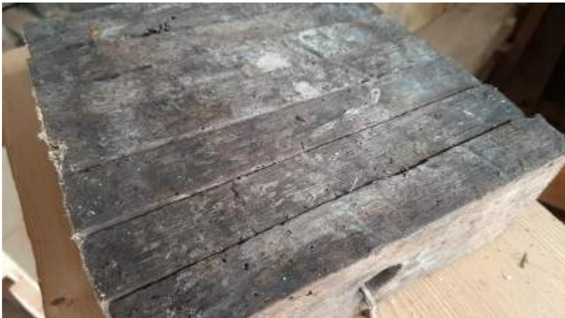
Figura 6: Superficie dei provini di quercia ripuliti, sulla cui superficie sono osservabili dei fori di ingresso delle teredini.
