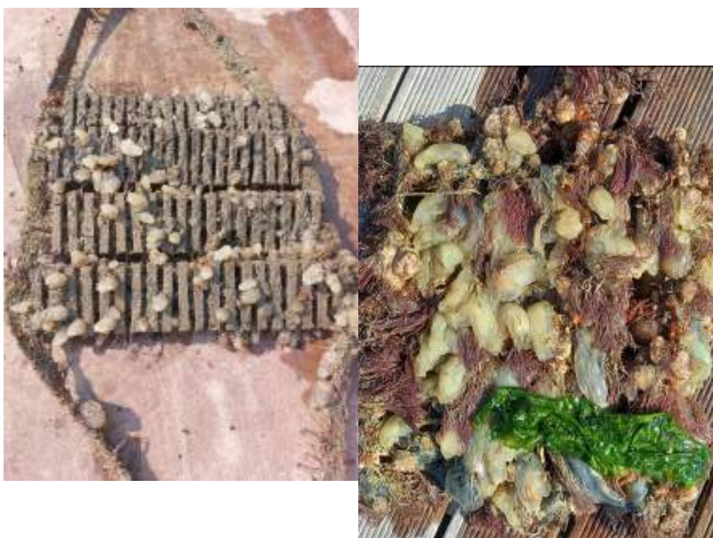
Figura 5: Fouling sui pannelli (luglio 2021), dopo 11 mesi a Capodistria (sinistra) e un mese dalla pulizia all'Arsenale di Venezia (destra).
