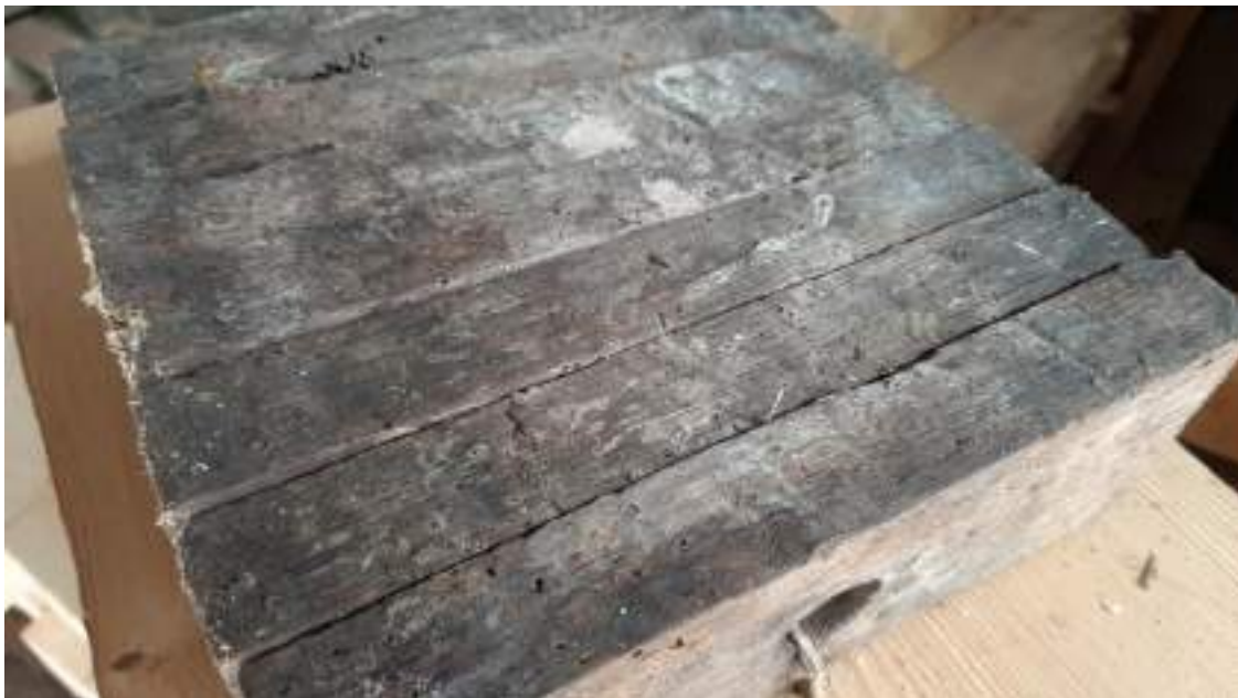
Slika 6: Površina očiščenih hrastovih vzorcev z opaznimi posameznimi luknjicami na površini
