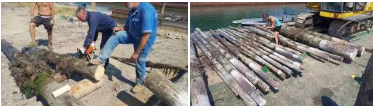
Foto 3.11: Preparazione dei campioni da laboratorio e catalogazione dei vari pali.
