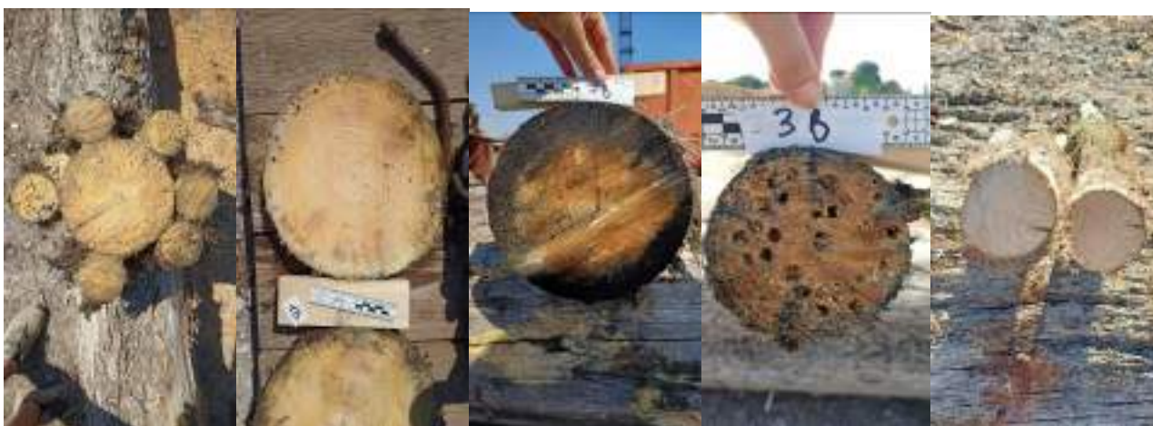
Slika 3.12: Primeri različnih prerezov obdelanih in neobdelanih kolov.
