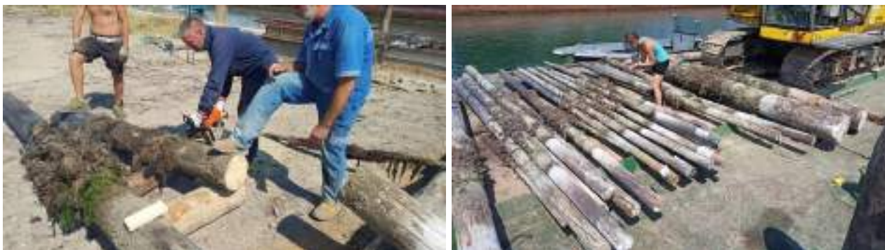
Slika 3.11: Priprava laboratorijskih vzorcev in katalogizacija različnih kolov.
