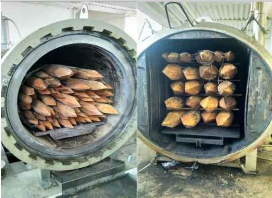
Slika 8: Levo - priprava dela kolov na vakuumsko-tlačno impregnacijo z eno od testnih raztopin; desno – del kolov, zaščiten s postopkom termične modifikacije.
