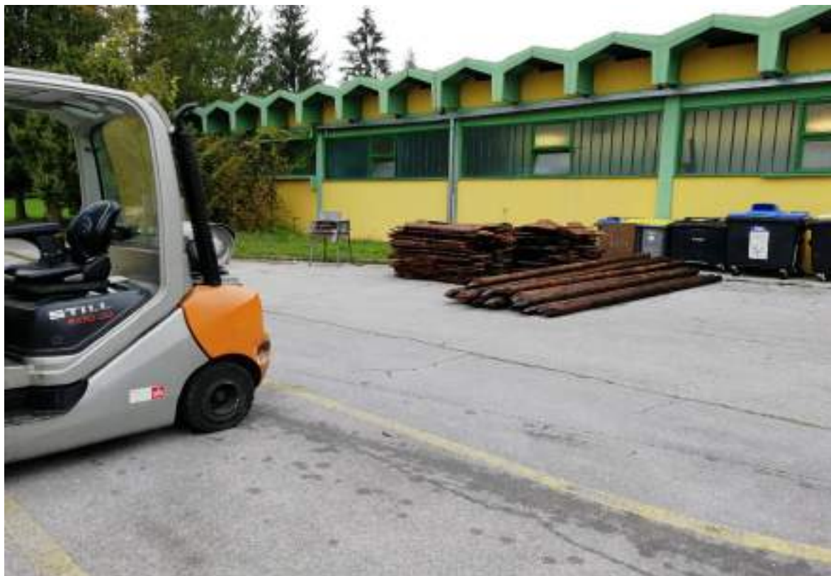
Immagine 9: Pali raggruppati per trattamento; a sinistra pali impregnati sottovuoto in autoclave, a destra pali di controllo non trattati.
