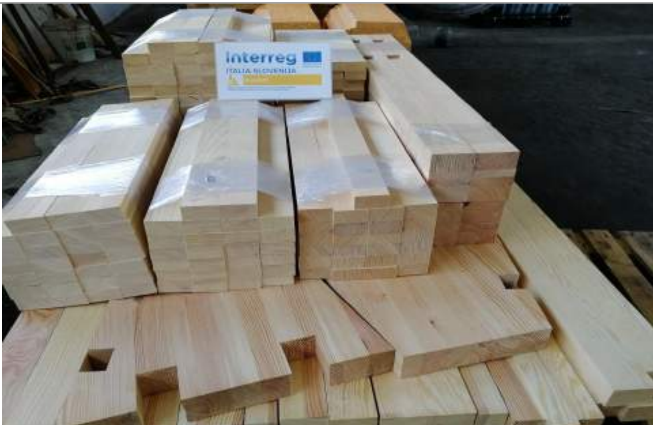
Slika 5: Vzorci EN 252 za terenska testiranja v zemlji (zgoraj, pod logotipom DuraSoft) v delovnem sklopu WP 3.2.3 v aktivnosti ATT10, pod njimi pa so vidne noge testne klopi, ki so se testirale v delovnem sklopu WP 3.2.4 v aktivnosti ATT11, tik pred impregnacijo z eno od testnih raztopin po vakuumsko-tlačnem postopku.
