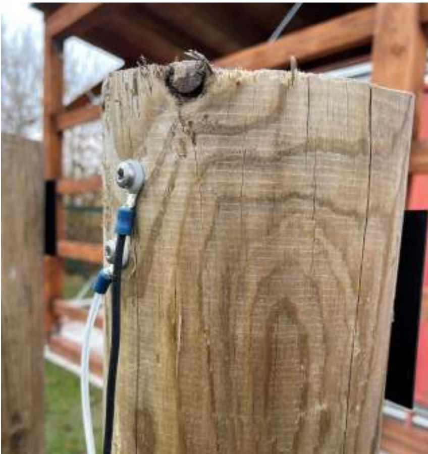
Immagine 16: Sensori sui pali per il monitoraggio dell'umidità del legno.
