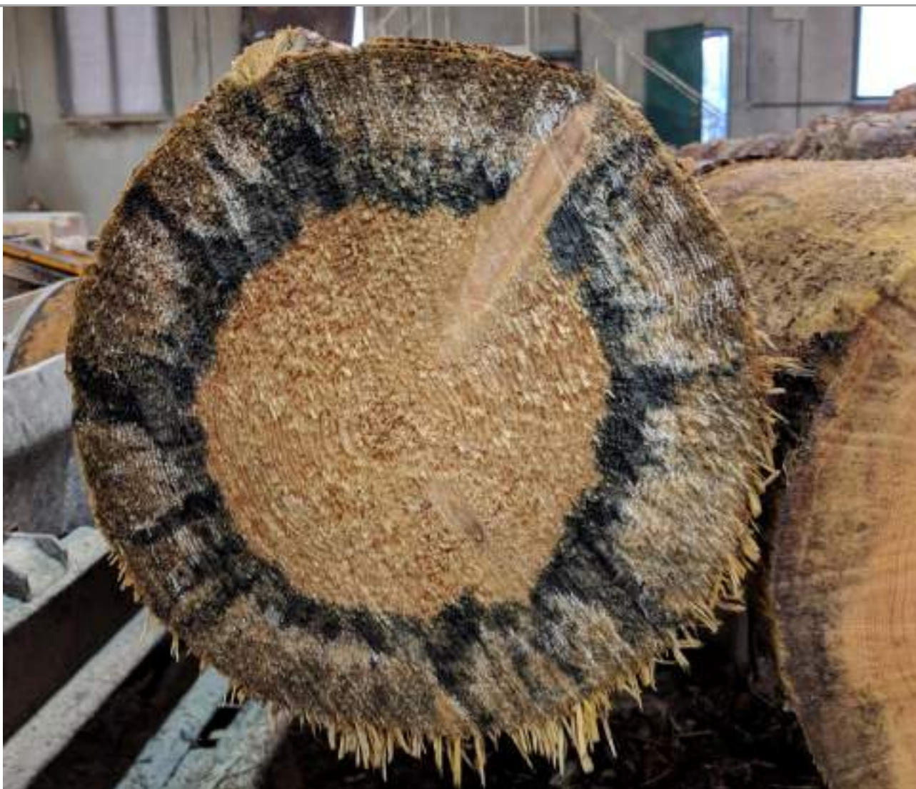
Immagine 1: Ceppo con tipica colorazione ascrivibile ad attacco da fungo dell'azzurramento, immesso nel legno da parte del bostrico tipografo.
