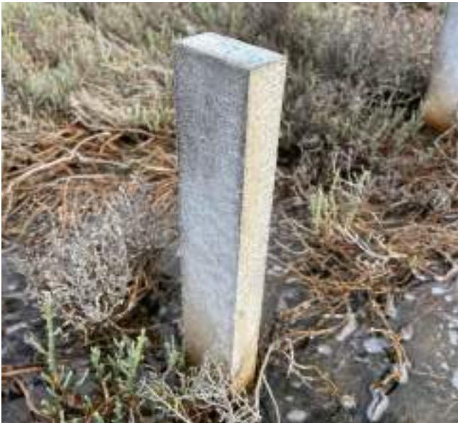
Immagine 10: Le fibre sul legno si sono sviluppate durante i 18 mesi nei quali sono state in contatto diretto con l'ambiente salato di Venezia.
