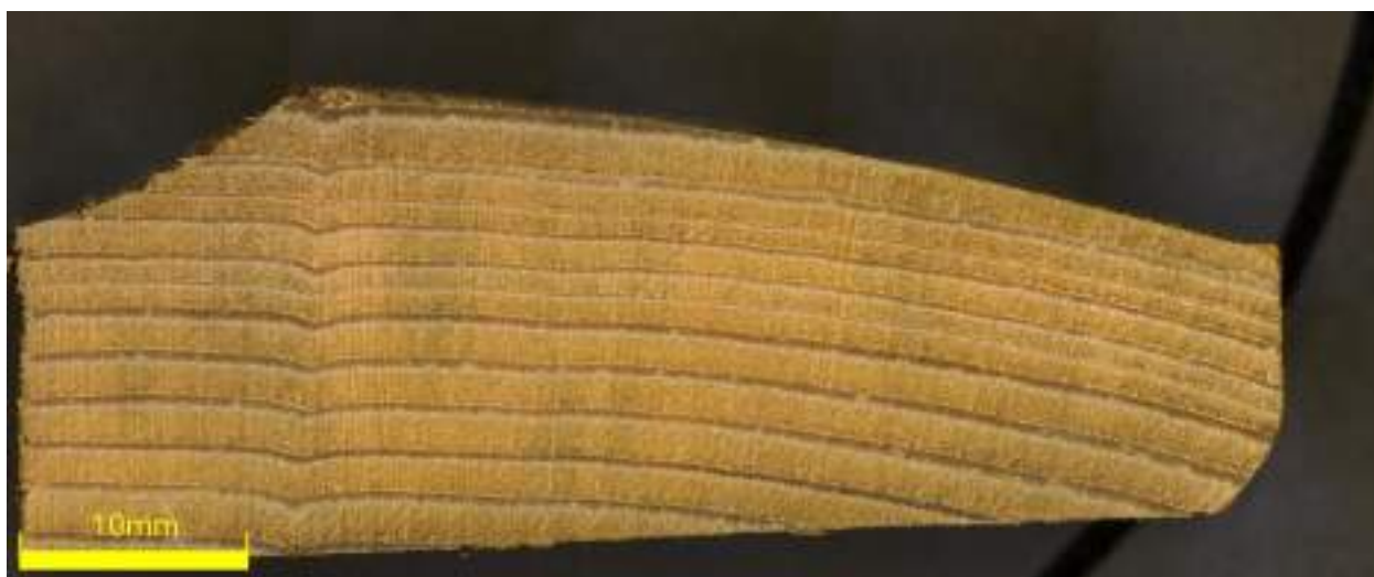
Immagine 21: Sezione della scandola in abete impregnata con Silvanolin, dopo otto anni dalla posa.
