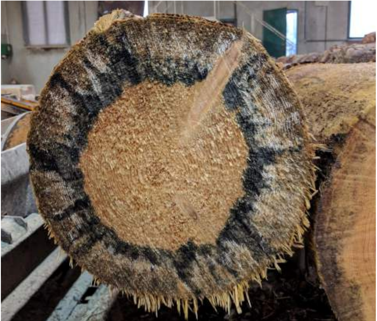
Slika 1: Hlod, z značilnim obarvanjem, ki je posledica delovanja gliv modrivk, ki jih je v les zanesel luadar
