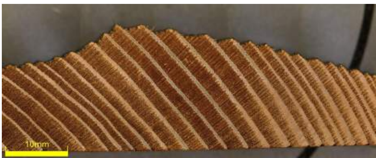
Slika 20: Presek termično modificiranega smrekovega strešnika osem let po vgradnji
