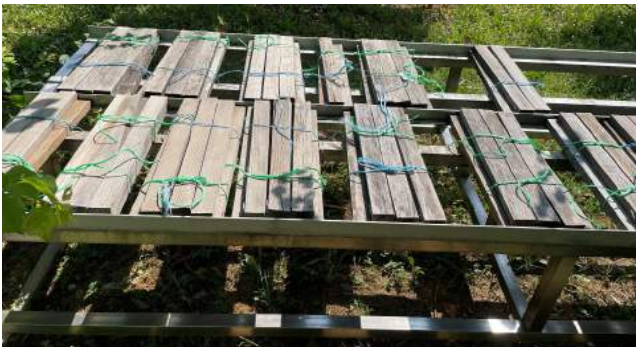
Slika 3: Izpostavitve vzorcev v dvoslojnem testu v Biljah po petih letih izpostavitve leta 2022
