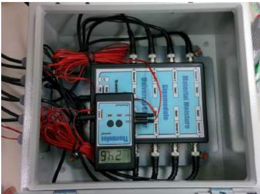
Slika 15: Merilnik lesne vlažnosti Gigamodul in oprema za beleženje podatkov Thermofox v jekleni komori. Črne žice vodijo do senzorjev za določanje vlažnosti, rdeče do senzorjev za določanje temperature. Poleg merilne tehnike, smo v komoro vstavili še silikagel.
