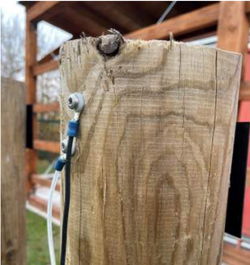
Slika 16: Senzorji za spremljanje vlažnosti lesa na kolih
