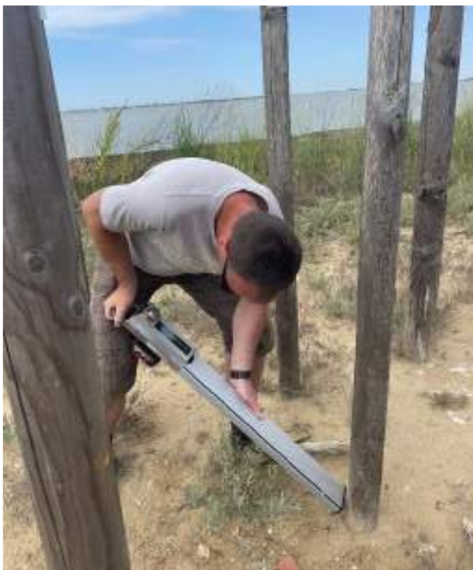
Slika 13: Ocena razkrojenosti kolov z rezistografom v Benetkah
