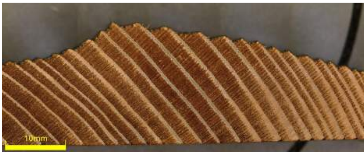
Immagine 20: Sezione della scandola in abete modificato termicamente, dopo otto anni dalla posa.
