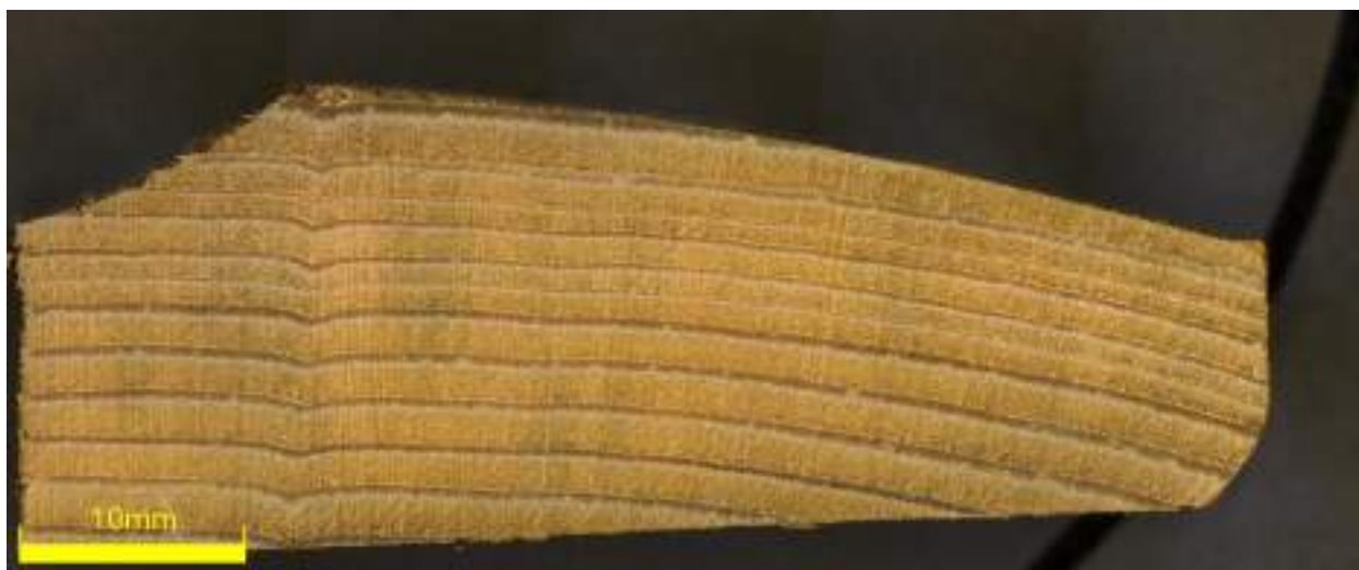
Slika 21: Presek s silvanolinom impregniranega smrekovega strešnika osem let po vgradnji
