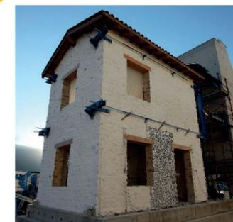
Edificio pilota sottoposto a prova sperimentale: vista e diagramma carico-spostamento in sommità. Pilotna zgradba med preiskavo in diagramm odziva v obliki obremenitev-premik na vrhu.
