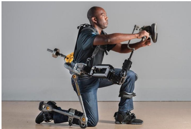
Slika 38 Zunanji skelet FORTIS omogoča prenos teže orodja za zunanje „noge“, ki to težo nato prenesejo zunaj telesa na tla. To upravljavcu omogoča, da se osredotoči izključno na natančno opravljanje dela, ne da bi ga skrbela obremenitev zaradi orodja.
