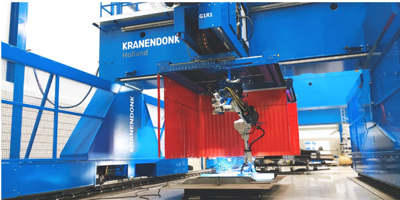
Figura 17 Soluzione di saldatura robotica di Kranendonk per pannelli metallici navali
