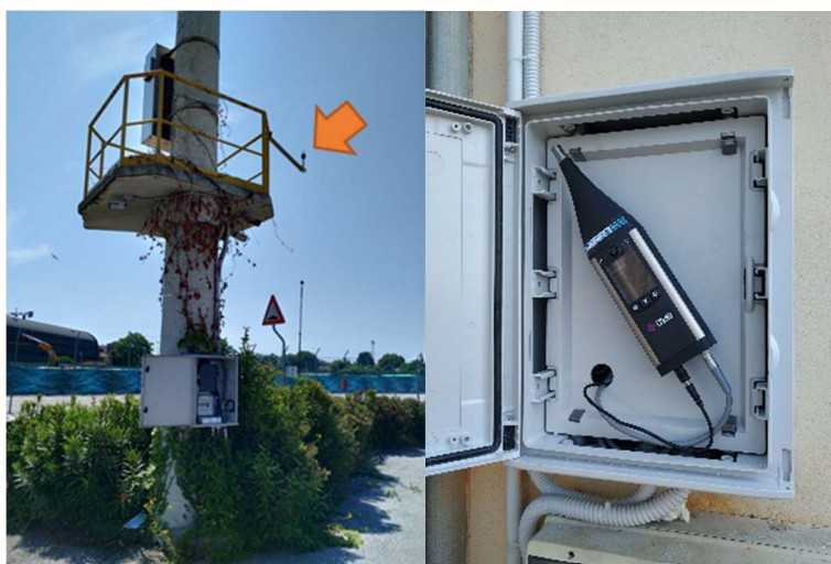
Figura 4 – Immagini dell’installazione delle centraline fonometriche nei siti individuati nel corso delle indagini preliminari.
