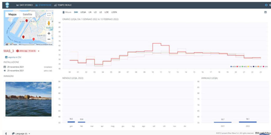
Figura 8 – Esempio di analisi di dati aggregati e di rappresentazione di analisi statistiche mediante la piattaforma web NOISEMOTE.
