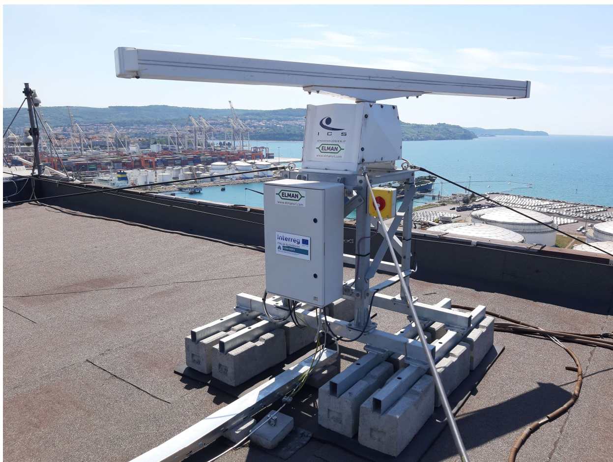
Slika 3: nov radarski sistem za zaznavanje ogljikovodikov na morski gladini v uporabi
