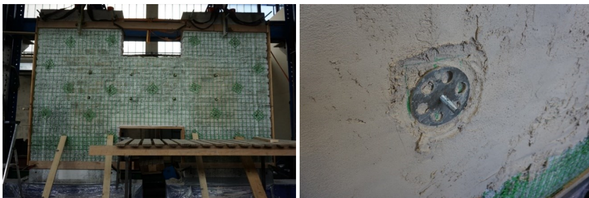
Slika 6: Mreža in sidra (levo) in sidna glava povezovalnega sidra (desno).
