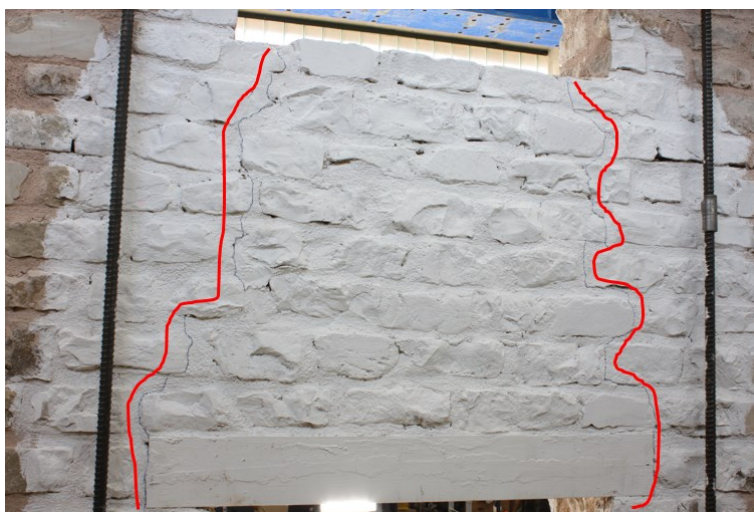
Slika 11: Upogibne razpoke v neutrjenem delu prekladnega zidu.
