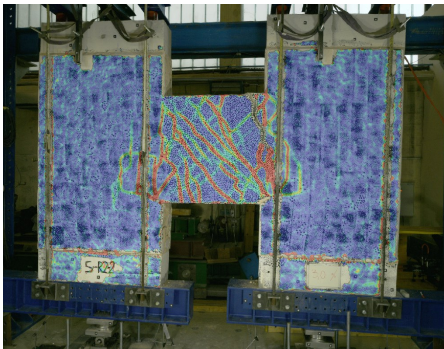
Slika 14: Strižne razpoke na oblogi enostransko utrjenega zidu. Rdeča barva prikazuje lokacijo in širino razpok.
