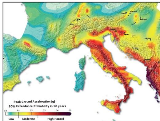
Fig. 2: ESHM13 seismic hazard map.
