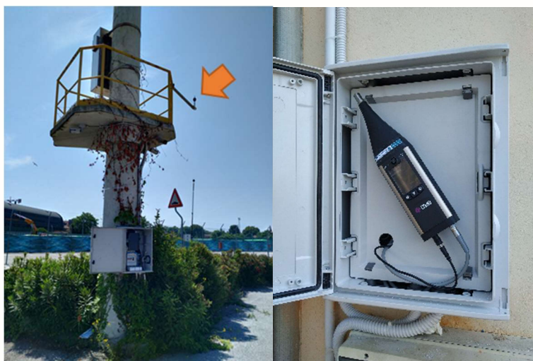
Slika 12: Prikaz namestitve merilnih postaj za merjenje ravni zvoka na lokacijah, določenih v fazi pripravljanih raziskav (AdSP MAS)
