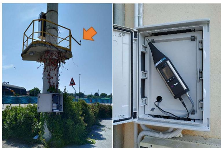
Figura 12: Centraline di monitoraggio fonometrico, installate nelle posizioni, individuate durante la fase preparatoria (AdSP MAS)
