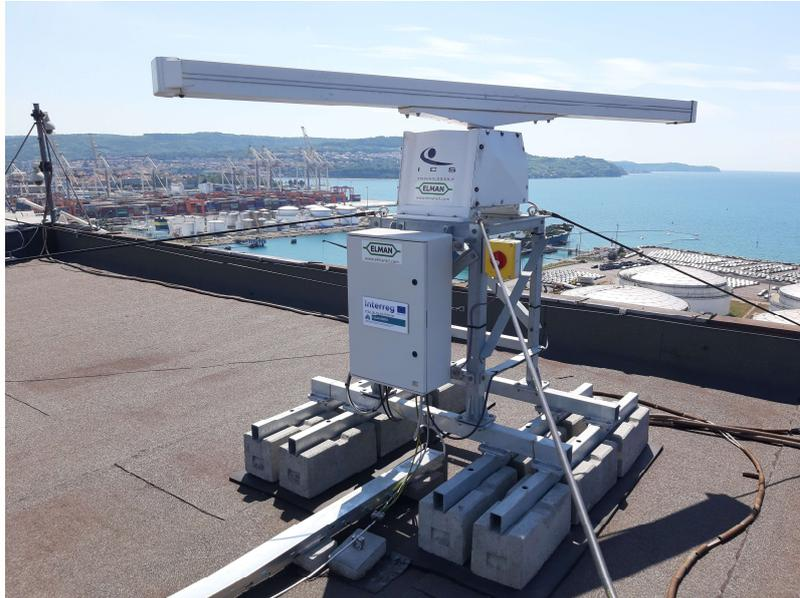
Figura 13: Il nuovo sistema radar per il rilevamento di tracce di idrocarburi sulla superficie di mare in funzione (Luka Koper)
