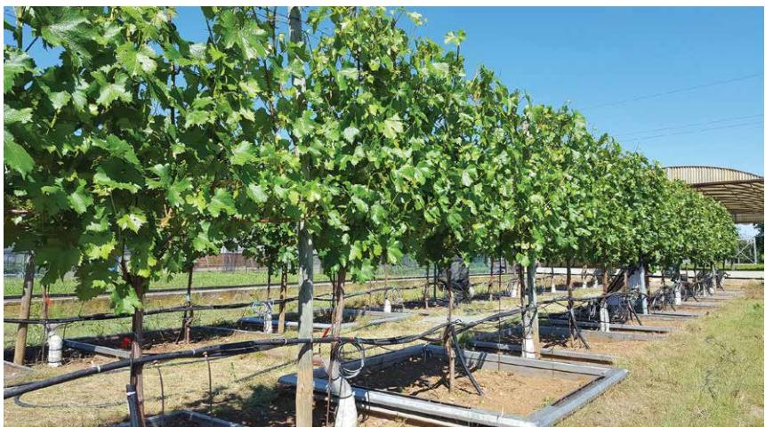
*Foto 3: Set up di lisimetri presso l'Azienda Agraria Servadei. In fondo si può notare il tetto mobile che viene azionato all'inizio di una pioggia grazie ad un sensore di bagnatura.*
