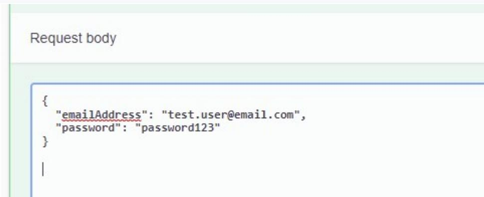
Na koncu kliknite gumb "Izvedi". Izveden bo klic v bazo podatkov in, če so poverilnice pravilne, bo aplikacija odgovorila z uporabniškimi podatki in ključem za preverjanje pristnosti:
