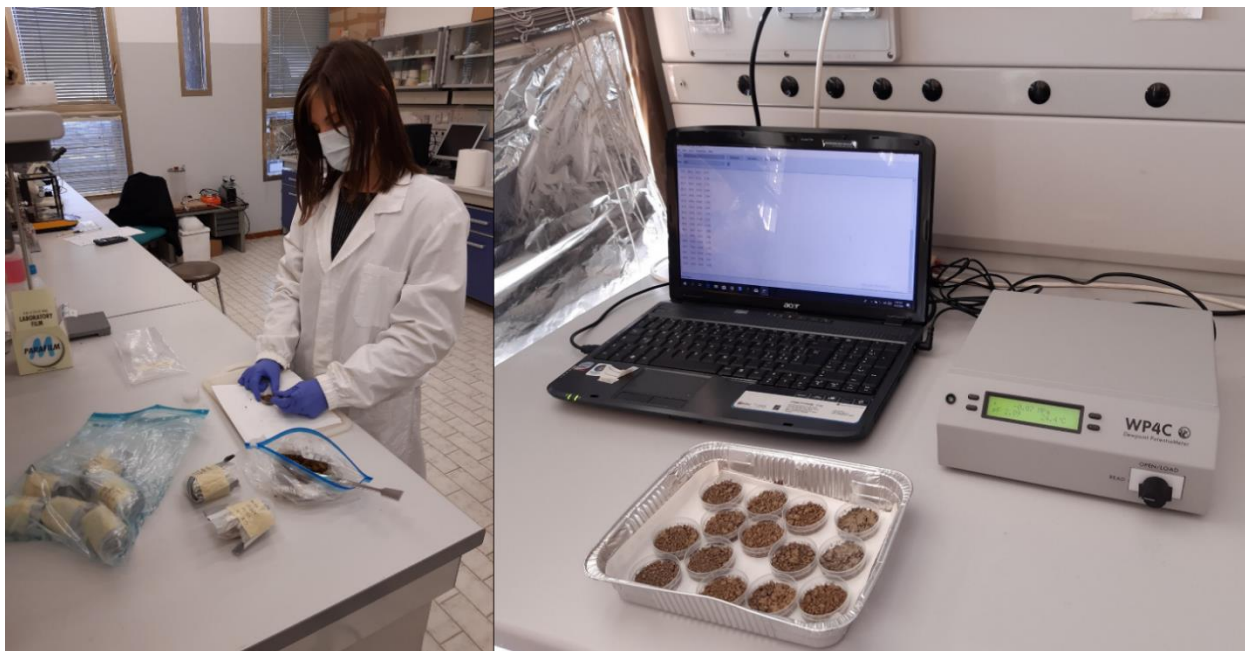
SLIKA 4: Priprava vzorcev tal za merjenje vlažnosti in vodnega potenciala z rosiščnim higrometrom.
