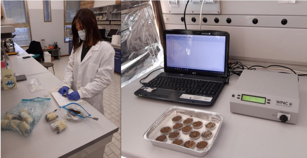
FIGURA 4: La preparazione dei campioni di suolo per la misura del potenziale dell'acqua con l'igrometro a punto di rugiada.
