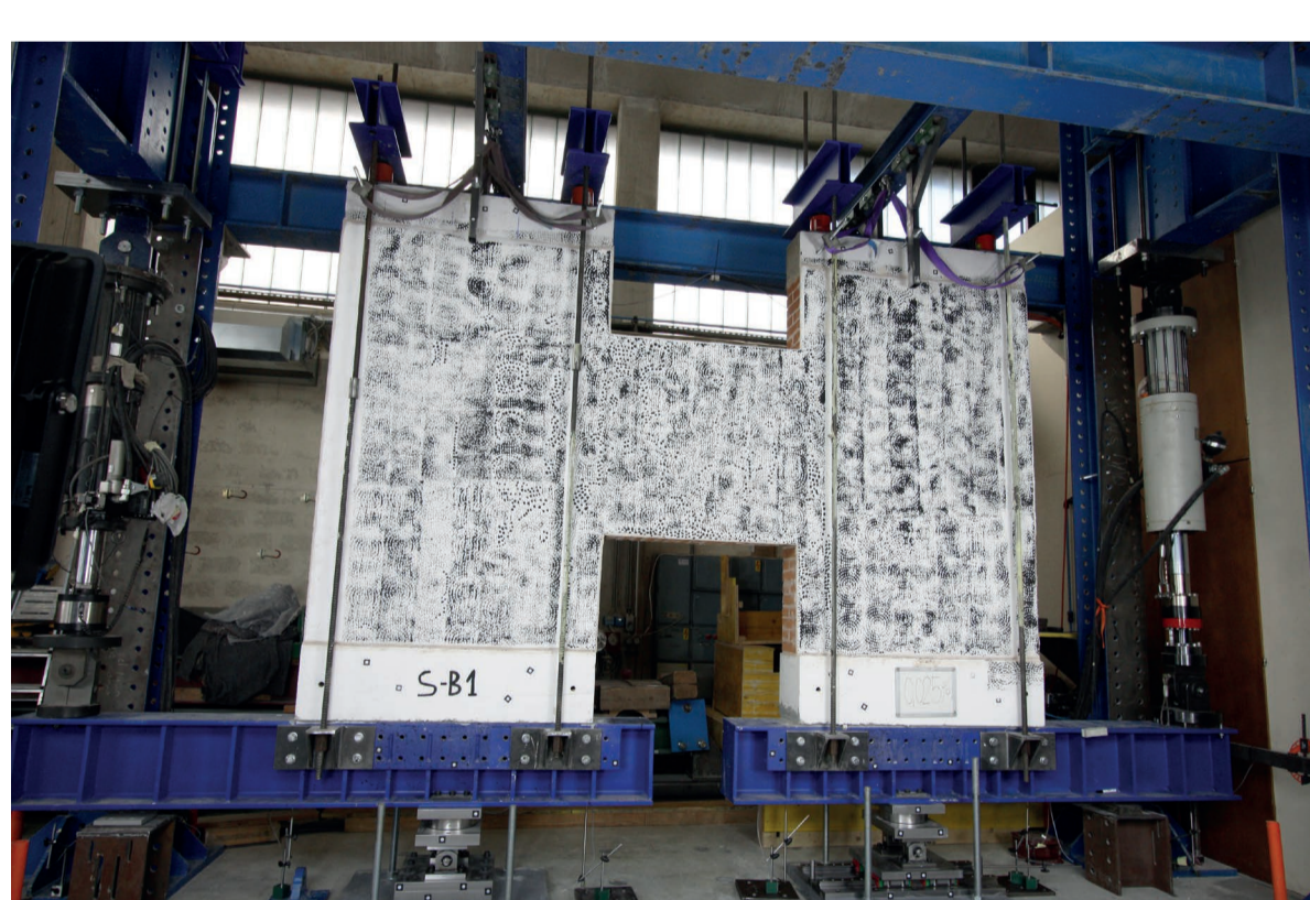
Foto prova di taglio-flessione su traversa soprafinestra.
