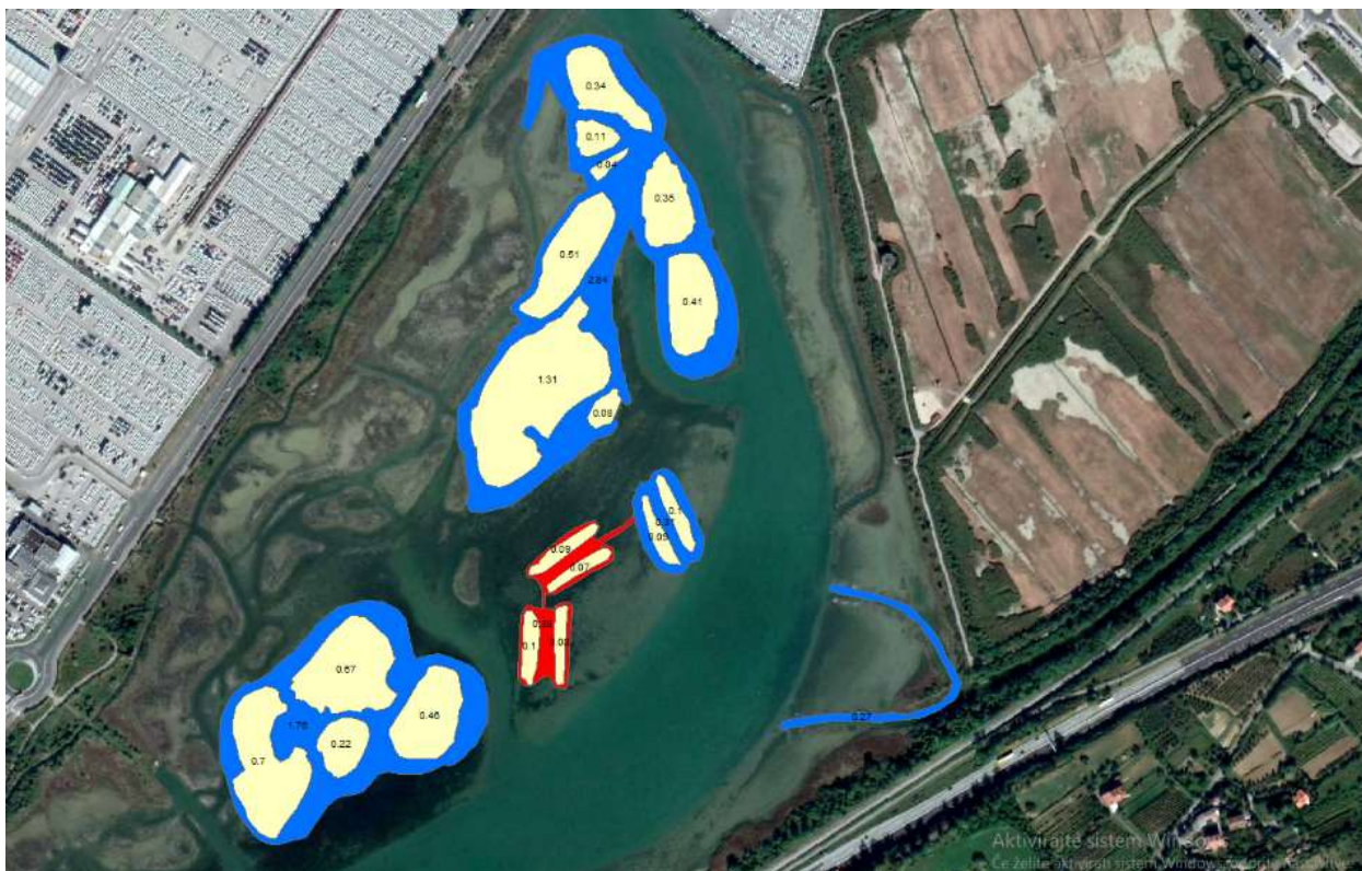
Slika 1: Načrt za adaptacijo umetnih otočkov v Naravnem rezervatu Škocjanski zatok. Z modro barvo je označeno poglobljanje sekundarnih kanalov z refiliranjem in deponiranjem materiala na bližnje otočke in sicer na mestih, kjer so muljasta tla najnižja in na katerih halofitna vegetacija trenutno ni več razvita. Z rdečo barvo so označeni izkopi kanalov širine od 5m (plovni kanal) do 10 m. Dolžina načrtovanih, novo oblikovanih, gnezditvenih otočkov bi bila od 5 do 7 m.
