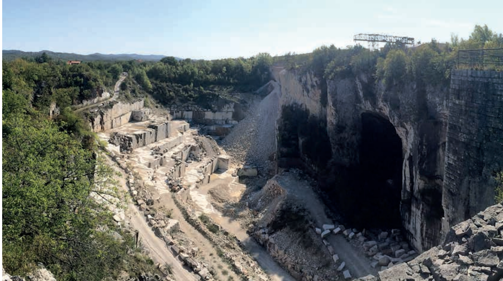
Figura 5.1.2: La Cava Romana di Aurisina-Nabrežina: a sinistra gli scavi su versante, in destra gli scavi in galleria (non più attivi) (Foto: Giancarlo Massari)
