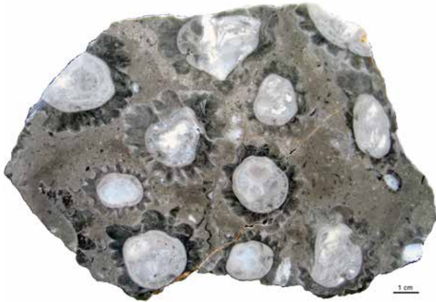
Figura 3.3.11: Campione lucidato di calcare di Lipica con una sezione trasversale di un cluster di rudiste (Foto: Bogdan Jurkovšek)
