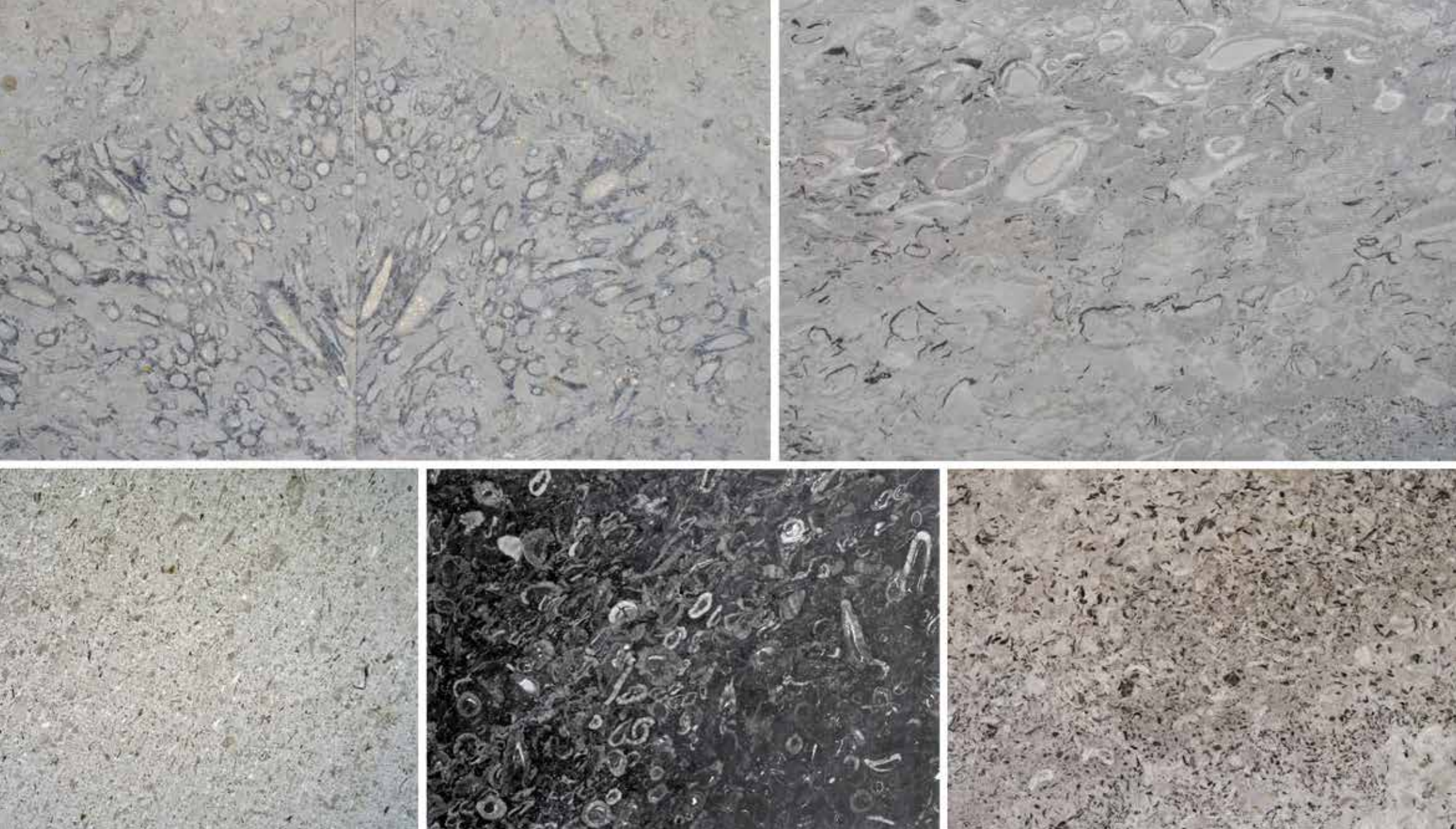
Figura 5.1.5: Alcuni campioni di Lipica fiorito (in alto a sinistra) e di Lipica unito (in basso a sinistra), tratti dalla cava di Lipica (denominati Aurisina Fiorita e Aurisina Chiara), di Repen (in alto a destra) e di Kopriva (in basso a destra) provenienti dalle cave di Doline (Repen Classico Zolla e Repen Classico Chiaro) e il nero scuro Kazlje (Foto: Bogdan Jurkovšek)
