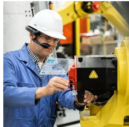
Slika 39 Očala za podprto resničnost RealWear Navigator 500 izboljšajo produktivnost delavca, saj ima med opravljanjem dela proste roke ter dostop do digitalnih podatkov in vizualne podpore na daljavo.
