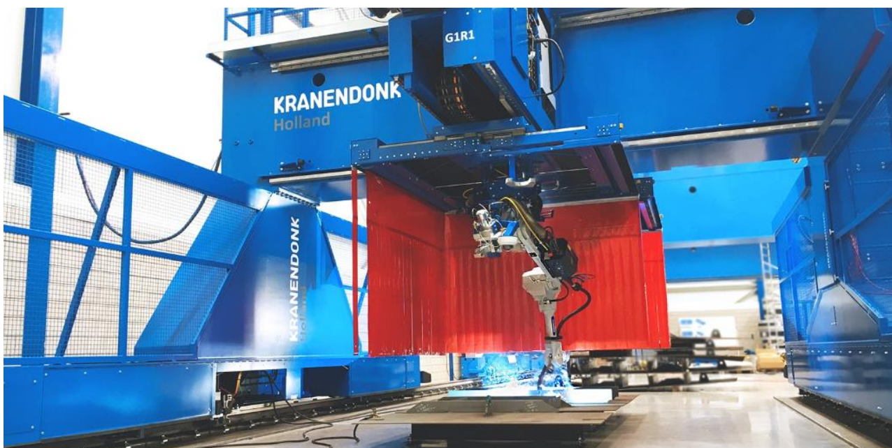
Slika 17 Robotska rešitev podjetja Kranendonk za varjenje kovinskih plošč v pomorstvu
