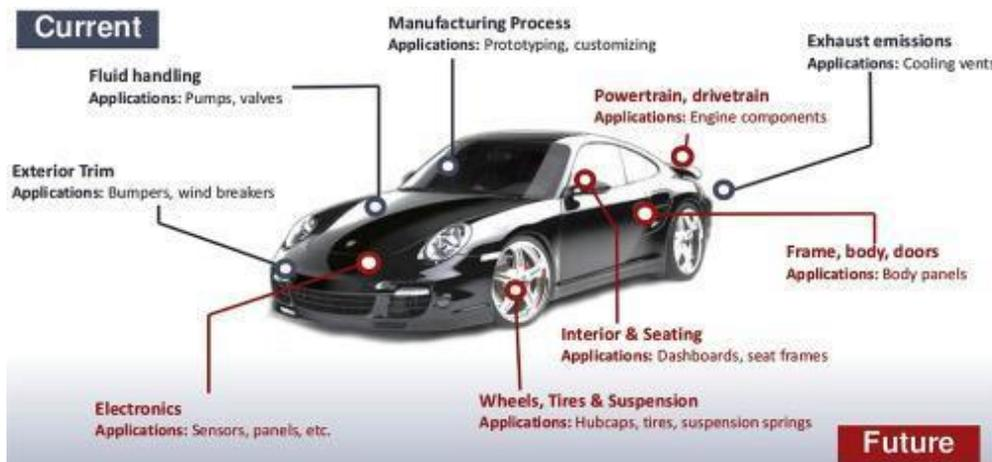
Figura 33 Future applicazioni dell'AM nel settore automobilistico [50]
