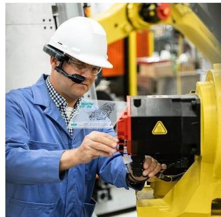
Figura 39 Gli occhiali per la realtà assistita RealWear Navigator 500
