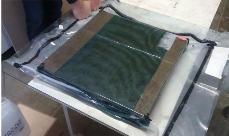
**Figura 3:** Preparazione della piastra in CFR semplice mediante stampaggio con sacco da vuoto (fonte: documentazione fotografica interna ZAG).
