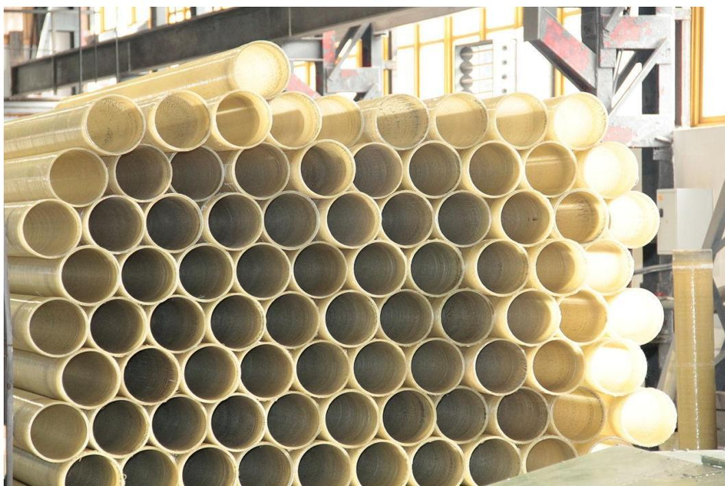
**Figura 11:** pila di tubi GFRP (fonte: Изоревуч su Wikimedia Commons).
