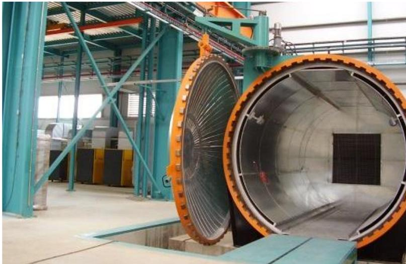
**Figura 4:** Un esempio di configurazione dello stampaggio in autoclave (fonte: JaviRD su Wikimedia Commons).
