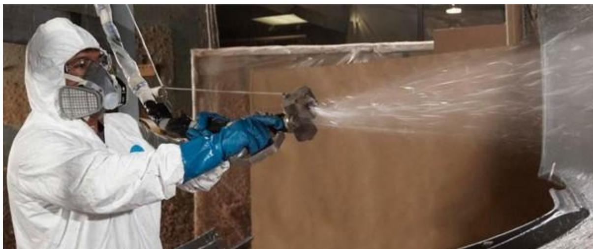
**Figura 8:** Il lay-up della miscela di fibra di vetro / resina con la pistola chopper (fonte: foto su [www.graco.com](http://www.graco.com)).
