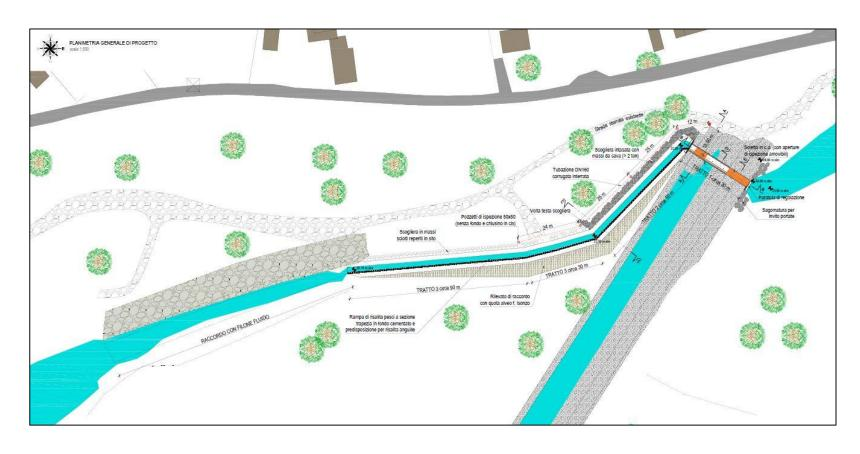
LUNGHEZZA SCALA 200 metri DISLIVELLO SCALA 4 metri
