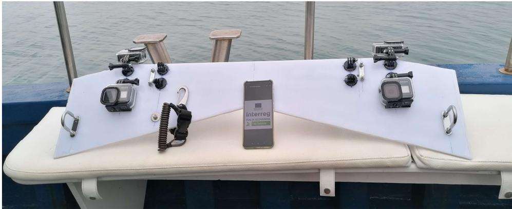
Prototipo **WinGo**, struttura alare portante equipaggiata con 4 action camera GoPro, per rilievi rapidi in immersione; tecniche di ricostruzione fotogrammetrica ottimizzate per il Nord Adriatico (elevata torbidità):
